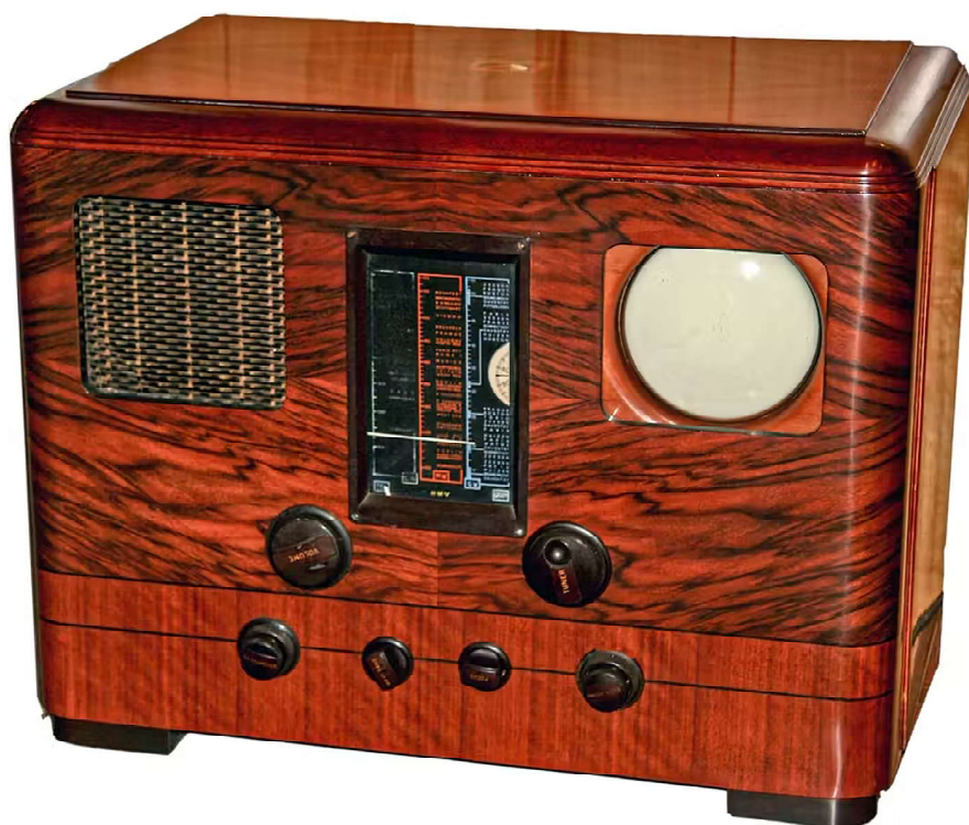
Receptor HMV 904, creado y ensamblado en el Reino Unido, 1938. Era un aparato multibandas, capacitado para recibir emisoras de origen trasatlántico y las primeras emisiones de televisión generadas en Europa y Estados Unidos.
